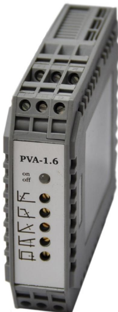
Mit dem Verstärkermodul PVA – 1.6 können Proportionalventile bis zu einem Strom von 3 A problemlos angesteuert werden. Die Steuerelektronik ist in ein Plastikgehäuse eingebaut, das direkt auf Tragschienen nach DIN 46277/1 und 46277/3 eingeschnappt werden kann. Dadurch wird eine einfache Montage möglich. Die Schraubklemmen befinden sich an den Seitenwänden, so dass die Kabel ohne zusätzlichen Sockel direkt am Gehäuse angeschraubt werden können.
