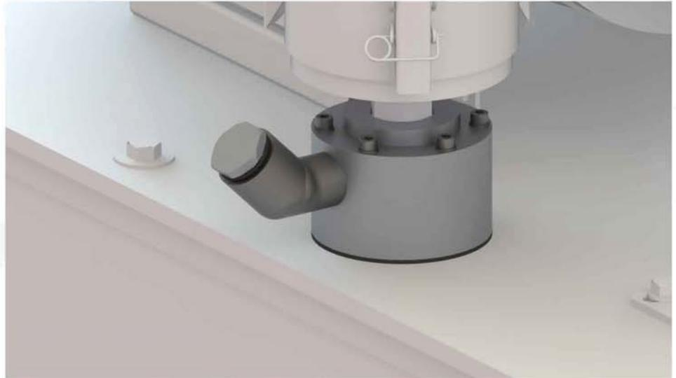
1. Verschlusschraube am Einfüllstutzen entfernen
