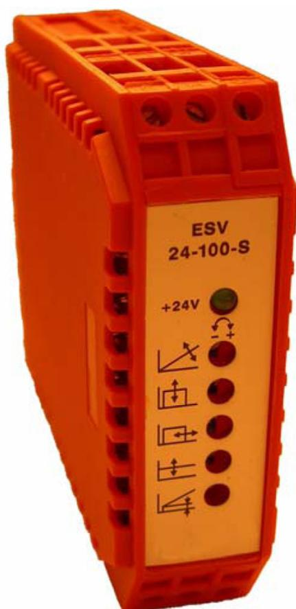
Das Verstärkermodul ESV – 24 ist für die Ansteuerung von Servoventilen bis Stromstärken von 100 mA geeignet. Das Modul ist in ein Plastikgehäuse eingebaut, das auf Tragschienen nach DIN 46277/1 oder 46277/3 eingeschnappt werden kann, was eine einfache Montage ermöglicht. Die Schraubklemmen befinden sich an den Seitenwänden, so dass die Anschlusskabel direkt am Gehäuse angeschraubt werden können.
