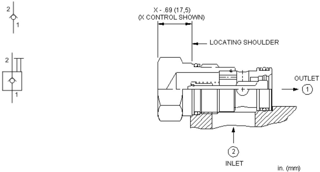
Rückschlagventile von SUN sind schaltende Ventile. Diese Version gibt den Volumenstrom von Anschluss 2 nach 1 frei und sperrt in umgekehrter Richtung.
