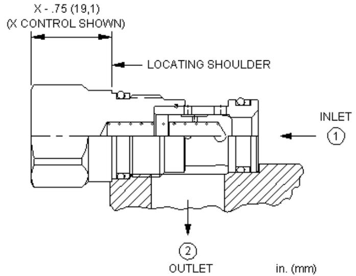
Rückschlagventile von SUN sind schaltende Ventile. Diese Version gibt den Volumenstrom von Anschluss 1 nach 2 frei und sperrt in umgekehrter Richtung.
